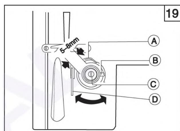
назад и в конце затяните регулировочный винт (A).
