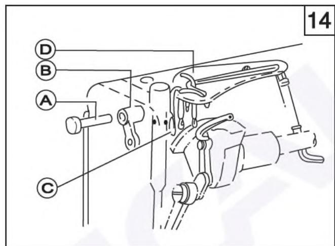
d. открутите два винта крепежной пластины масляной нити в верхней части (слева) корпуса машины, выньте крепежную пластину масляной нити (D) из головки машины.
