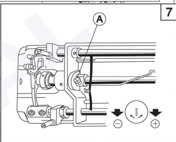
(в направлении знака «-»), то расход масла уменьшится. Винт регулировки количества масла (A) регулирует расход масла в пределах 5 оборотов, если винт затянут, то расход масла максимальный, а если открутить винт на 5 оборотов, то расход масла будет минимальным.
