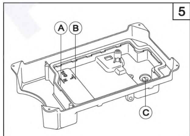
должен быть ниже метки (В), в противном случае может прекратиться подача масла к отдельным частям машины, что приведет к нагреву и заклиниванию.
