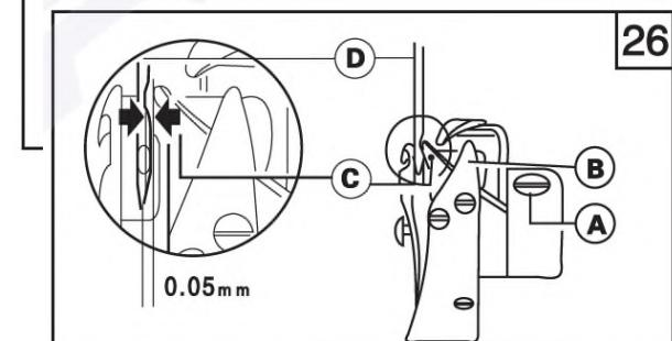
эффективность шитья. Стандартная синхронизация: поверните рукой маховое колесо, чтобы игла опустилась в максимальное нижнее положение, а затем поднимите снова на 2.5 мм. В это время, крючок для захвата нити вращающегося челнока(D) должен быть на одной линии с центром иглы (C), в этом положении, крючок для захвата нити (D) должен быть выше игольного ушка (E) примерно на 1.2 мм.
