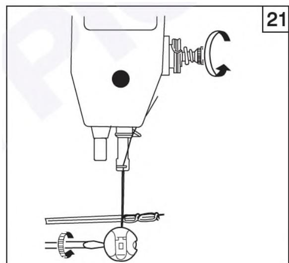
верхней нити. Или с помощью маленькой отвертки затянуть винт на шпульном колпачке, чтобы усилить натяжение нижней нити.
