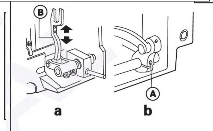
между передним краем зубчатой рейки и выемки игольной пластины должно составлять 1.5 мм. Это стандартное положение для установки зубчатой рейки.
